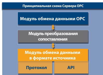
Рисунок 4: Принципиальная схема Сервера OPC – концептуально Сервер OPC можно разделить на три модуля: модуль обмена данными OPC, модуль преобразования/сопоставления и модуль обмена данными в формате источника.
