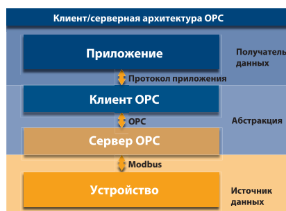
Рисунок 3: Клиент/серверная архитектура OPC – анализ уровня абстракции OPC позволяет выделить два компонента: Клиент OPC и Сервер OPC. Обмен сообщениями между этими компонентами осуществляется согласно спецификации OPC.
