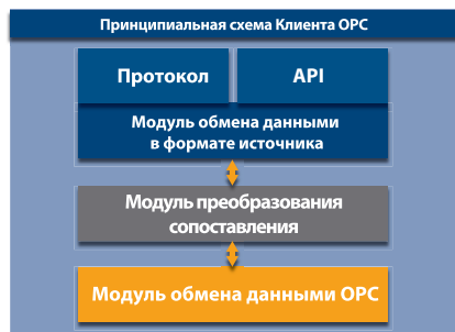
Рисунок 5: Принципиальная схема Клиента OPC – по аналогии с Сервером OPC. Клиент также можно разделить на три модуля: модуль обмена данными в формате приложения, модуль преобразования/сопоставления и модуль обмена данными OPC.
